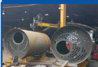
SOLDADURA POR ARCO SUMERGIDO
