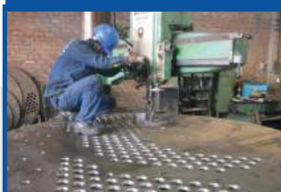
PERFORADO DE PLACAS
